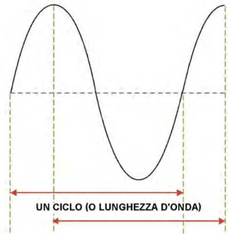
Onda sinusoidale, relazione Ciclo - Lunghezza d'onda © autore ►
